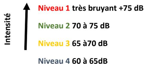
Le classement aboutit à la détermination du secteur de part et d'autre de la voirie, où une isolation acoustique renforcée des bâtiments est nécessaire.
